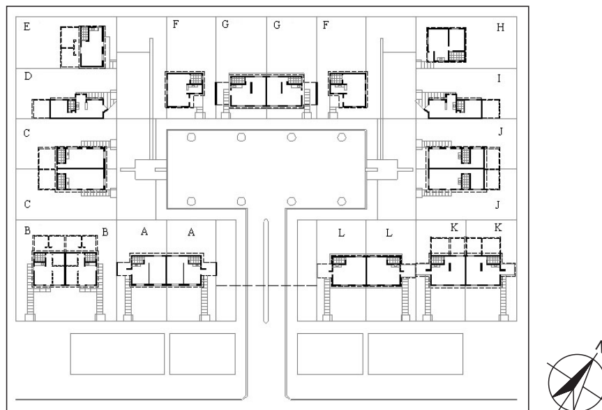
Figura 1 Planta baixa do Conjunto Demonstrativo de Tecnologias “V Centenário”, mostrando a implantação das habitações nos respectivos terrenos, em relação ao Norte Geográfico.
