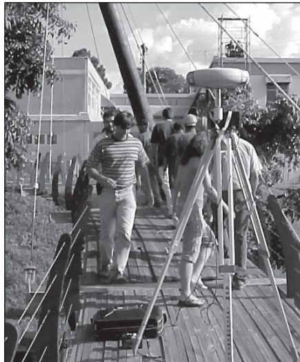
Figura 8 Vista frontal dos pedestres caminhando sobre a passarela e vista da antena GPS sobre o oscilador.
