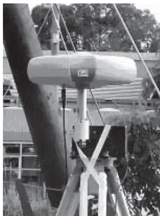
Figura 7 Vista da antena móvel sobre o oscilador eletromecânico.
